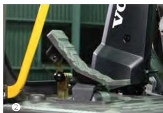
② (ブレーカ配管) ダブルペダル
